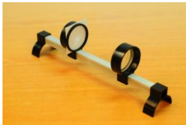
รูป การจัดเครื่องมือสำหรับหาความยาวโฟกัสของเลนส์นูน
