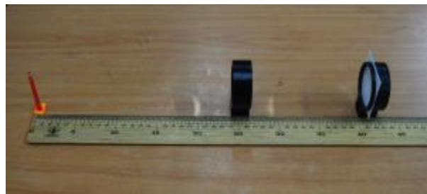
รูป การจัดอุปกรณ์สำหรับหาความยาวโฟกัสของเลนส์นูน
